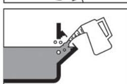
**D) Рекомендованное масло для смазки: Моторное масло для четырехтактного двигателя.**
